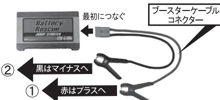
ブースターケーブルがしっかりと本体に差し込まれた事を確認後、最初にブースターケーブルの+クランプ（赤）を車載バッテリーの+端子に、次に-クランプ（黒）を車載バッテリーの-端子につないで下さい。
