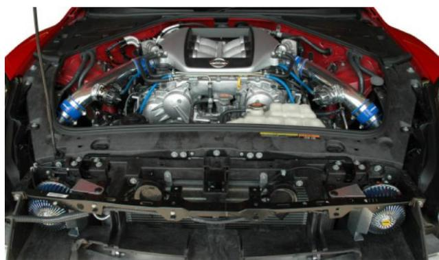
純正加工タービン対応用のサクシオンキット。吸入量の増大とレスポンスアップを狙い、既存の70φパイプ部を80φに拡大。フロントバンパー内にエアクリーナーを配置し、フレッシュエアを取り入れます。
